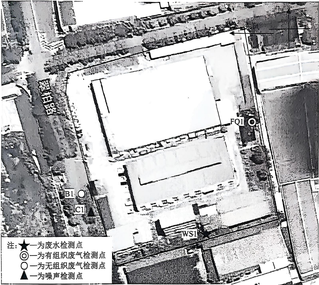
图 1 检测布点平面示意图
